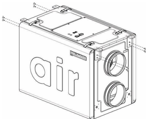
Rysunek 11. Montaż zawieszek sufitowych w rekuperatorach DRO.
